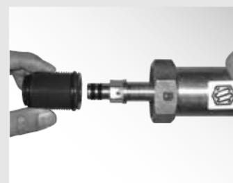
シールプラグを挿入機にセットし、挿入機頭部にハンドルを挿入し、蝶ネジを頭部溝に締め込み固定してください。
