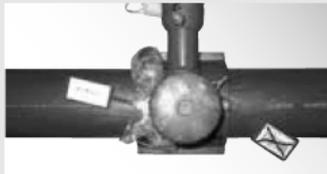
穿孔片を袋に入れて継手にぶら下げ、「プラグ挿入済」プレートがターミナルピンに取り付けてください。
